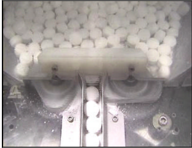
fig.5 MECANISMO DE SERIALIZACIÓN
