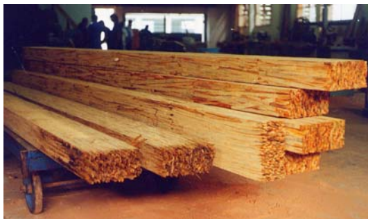
Figura 1. Parte de los elementos laminados CAÑALLAM y PINOLLAV , listos para ser aserrados para la obtención de vigas y bloques para probetas de ensayos.
