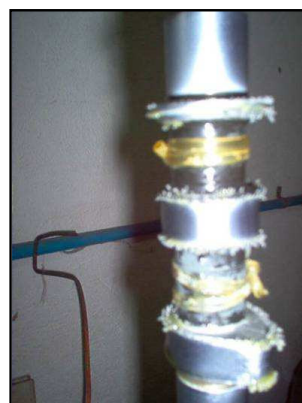
Figura 20. Cigüeñal recuperado mediante cromo duro
