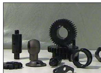
Fig.2 4- Uso del pavón en manillas y piezas de maquinarias industriales.
