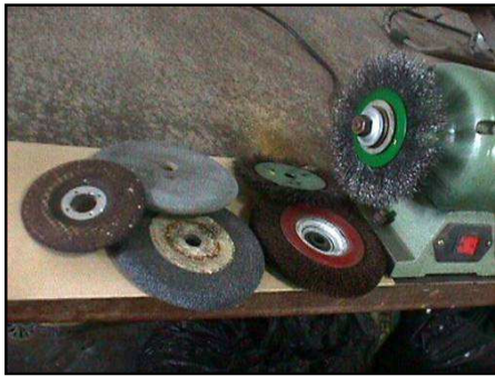
Figura 5. Otros tipos de cepillo para desbaste.
