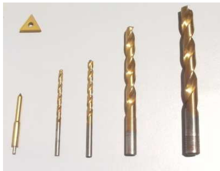
Figura 29. Muestra de herramientas con nitruro de titanio.
